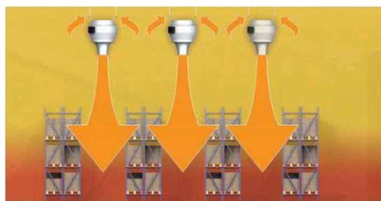
2.att. Gaisa temperatūras izlīdzināšanās pēc VENTS uzstādīšanas
